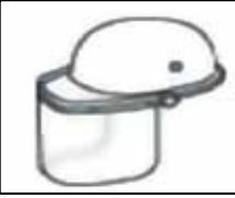
Koruyucu siperler Gözleri, yüzü ve uzunluğuna bağlı olarak boyunun bir kısmını korur.
